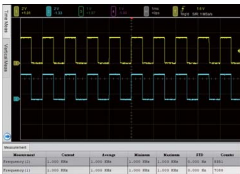
示波器量測 1KHz · 2.5Vpp 的方波
